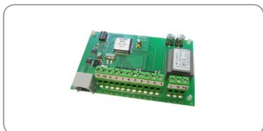
Le module GTM ECDDC est utilisé en cas de raccordement sur une GTC sans avoir besoin d'un boîtier de commande déporté.
