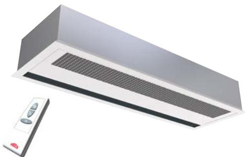
L'AR3200C est un rideau d'air encastré destiné aux bâtiments commerciaux et aux entrées tertiaires. Sa vitesse de soufflage est adaptée aux différentes hauteurs d'installation. Le rideau d'air dispose d'un système de commande intégré et peut également être commandé à distance via une télécommande.
