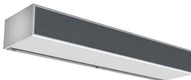
Le rideau d'air Linea Hybride associe avantageusement une batterie eau chaude et une résistance électrique. Grâce à cette combinaison, vous pouvez choisir plusieurs fonctions : Tout Electrique, Tout eau chaude ou Mixte. Dans ce dernier cas, la résistance électrique vient en complément de la batterie eau chaude lorsque la température de soufflage n'est pas atteinte. Les variations des régimes d'eau n'auront alors pas d'influence sur le confort et la température de soufflage restera constante.
