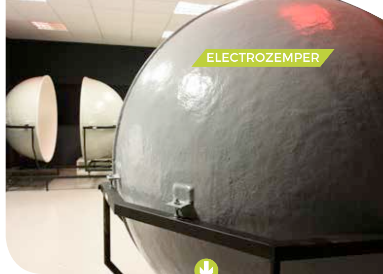
Sphère intégrante de Ulbricht pour mesure de flux
